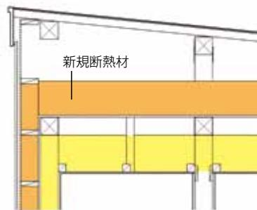
既存屋根を解体し、桁上に断熱材受けを造作。壁の外張り断熱と連続させて高い気密性能を得ることができる。
